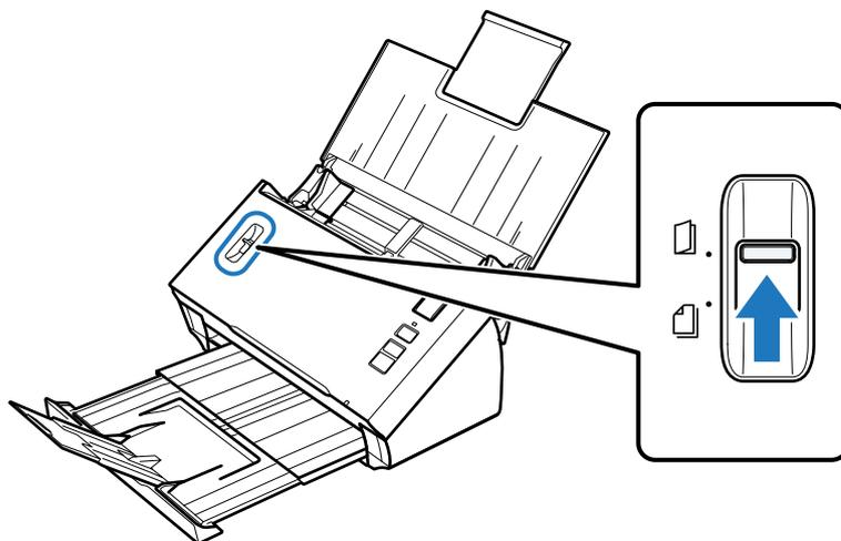
**4** 將卡片的列印面朝下，放入進紙托盤，並將上緣朝向進紙器。將卡片推入進紙器，直到感覺受阻，接著將紙張邊緣定位器推至卡片的邊緣靠齊。
