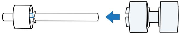
確認沒有存在任何間隙。請確定滾輪沒有脫離轉軸。
